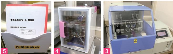
4 インキュベーター。細菌検査ができる一連のキットが用意されている 5 食品工場向けユニフォームの生菌数基準値を示した管理文書。一般生菌数はRALの基準値(脱水後:100cfu以下/100cm<sup>2</sup>、製品状態:50cfu以下/100cm<sup>2</sup>)に従っている 6,7 試験用洗濯機(6)。このサイズの機種でも回転数を任意に変えられる特注仕様になっている(7) 8 トンネルフィニッシャーの仕上げを再現できる試験用乾燥ボックス 9 テストサンプルのフライス。洗濯後に縮む問題をどう改善すればよいかという相談に応じて試験を行った。熱変性を考慮した洗濯処方に変更したことで解決した
